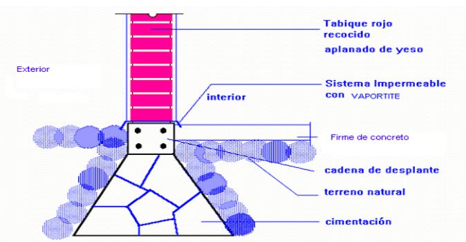
Procure que la corona de cimentación se encuentre seca. Elimine partes sueltas o flojas y salientes filosas o puntiagudas rasurando mediante pala plana.
